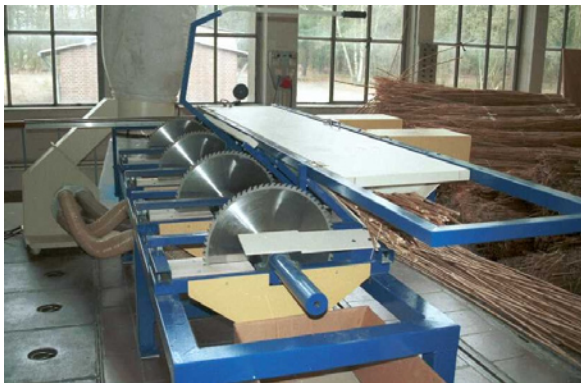
Abbildung 5: Halmbundsäge mit variabler Sägeblatteinstellungen
