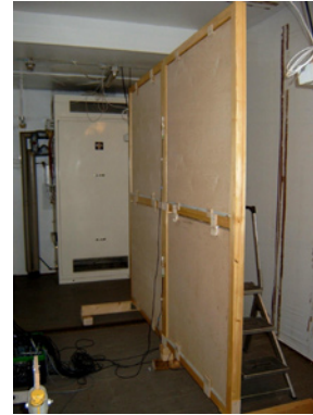
Abbildung 8: Versuchsaufbau zur Verformungsmessung in einer Zweiraum-Klimakammer
