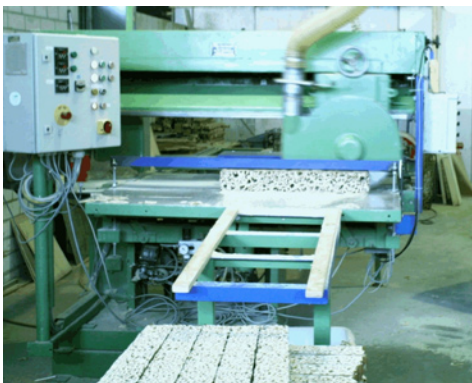
Abbildung 7: Schneiden der Kernstoffblöcke mit einer Plattenkappsäge
