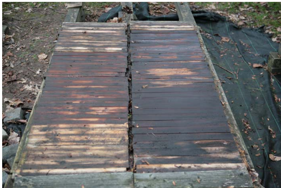
Abbildung 31: Unterlage der Laborplatten nach 24-monatiger Freibewitterung
