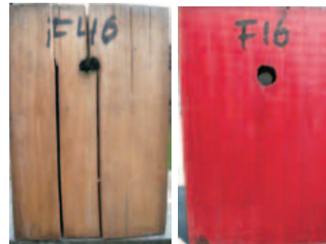
Abb. 3: Unterseiten eines unbehandelten (links) und Paraffin-behandelten (rechts) Fichtenprüfkörpers nach drei Jahren Exposition in 45° geneigter Doppellagenanordnung – Reverse sides of an untreated (left) and Paraffin-treated (right) spruce after three years of exposure in a 45° inclined double layer arrangement
