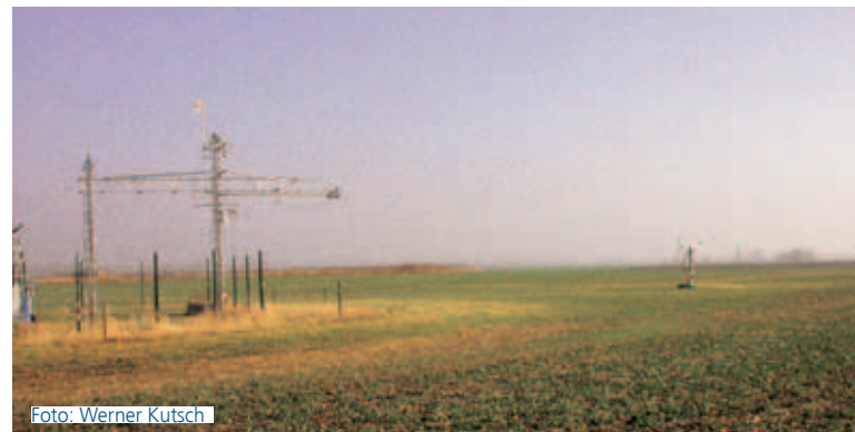
Abb. 4: Eddy-Kovarianz Station zur Messung von \text{CO}_2 -Flüssen zwischen Ackerfläche und der Atmosphäre in Gebesee, Thüringen. Die Messungen wurden von 2001 bis 2009 durch das Max-Planck-Institut für Biogeochemie in Jena durchgeführt und werden ab 2010 durch vTI-AK fortgeführt – Eddy covariance station for measuring carbon dioxide fluxes between a field and the atmosphere. The station is located in Gebesee, Thuringia. Measurements were conducted from 2001 to 2009 by Max-Planck Institute for Biogeochemistry in Jena and will be continued as of 2010 by the vTI Institute for Agricultural Climate Research
