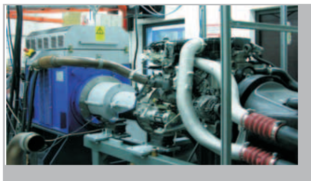
Abb. 10: Mercedes OM 904 Motor mit SCR-System im Emissionsprüfstand – Mercedes OM 904 engine with SCR-system on the emission test bench
