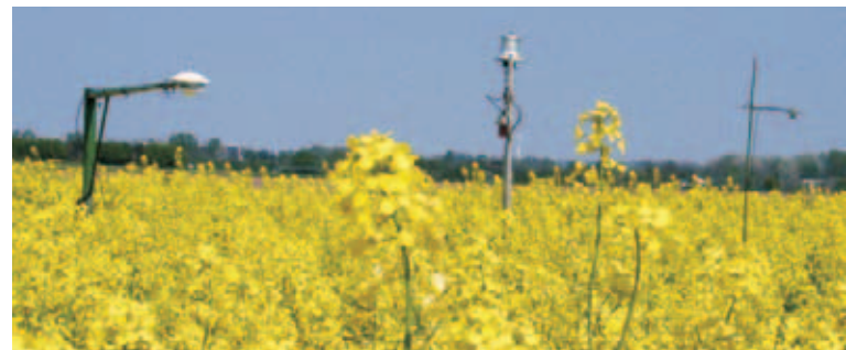
Abb. 5: Agrarmeteorologische Strahlungssensoren über einem Rapsbestand. Links: Albedometer, Mitte: Psychrometer (zur Messung der Luftfeuchtigkeit); rechts: ein abwärts- und aufwärtsgerichteter PAR-Sensor – Agrometeorological sensors above a rapeseed canopy. Left: albedo meter; centre: psychrometer (measurement of air humidity); right: downward and upward PAR sensor
