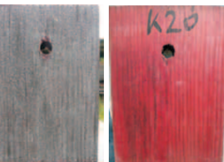
Abb. 5: Paraffin-behandelter Kieferprüfkörper nach drei Jahren Exposition in 45° geneigter Doppellagenanordnung – Decklage: Frontseite (links), Rückseite (rechts) – Paraffin-treated pine sapwood sample after three years of exposure in a 45° inclined double layer arrangement – top layer: front side (left), reverse side (right)
