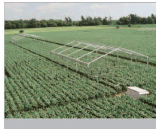
Abb 5: Maisfeld mit FACE-Ring zur Erhöhung der CO_2 -Konzentration und Zeltgerüsten zur Manipulation des Niederschlags – Maize field with FACE-rings for CO_2 enrichment and tent frames for control of precipitation
