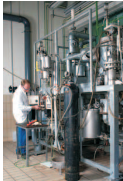
Abb. 7: Aufschlussapparatur zur Komponententrennung von Holz im 10-kg-Maßstab. Standort: Technikum HTB-Chemie – Pilot plant for component separation in 10-kg-scale. Location: Technical Center HTB-Chemistry
