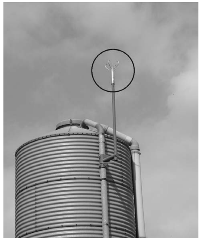
Abb. 4: Anordnung des Ultraschallanemometers auf dem Silo
