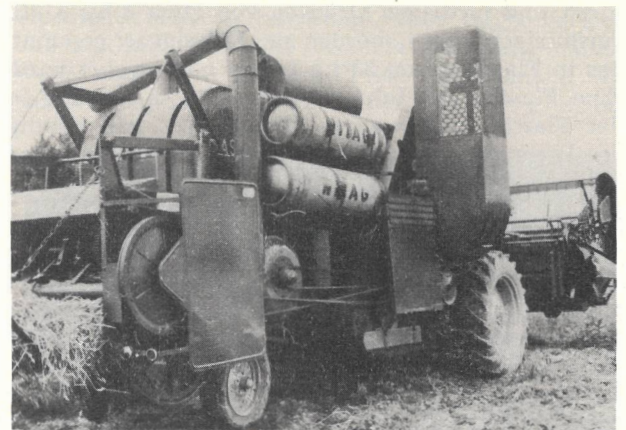
Bild 3: Anordnung der Flüssiggas-Flaschen für einen Selbstfahrer-Mähdrescher mit 52 PS Antriebsmotor.
