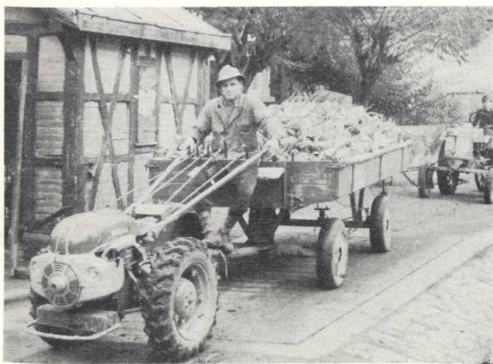
Abb. 10. Fahren von bis zu 2 t Nutzlast werden vom Einachsschlepper unter verhältnismässig schwierigen Bedingungen bewältigt.
