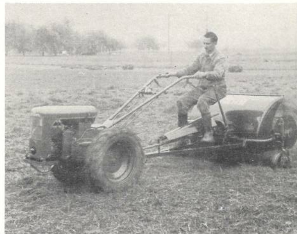
Abb. 8. Einachsschlepper beim Graszetten. Kein Eindringen des Grases in den Boden wie bei dem schweren Schlepper.
