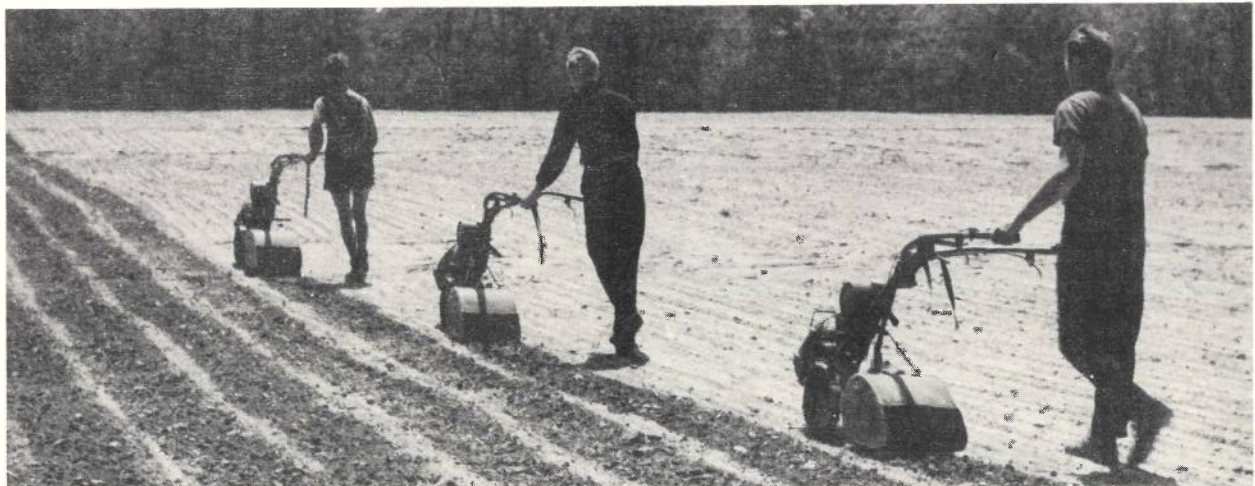
Abb. 14. Der Einsatz der leichten Hackfräse auf zum Verkrusteten neigenden Böden kann auch in Grossbetrieben Vorteile haben.
