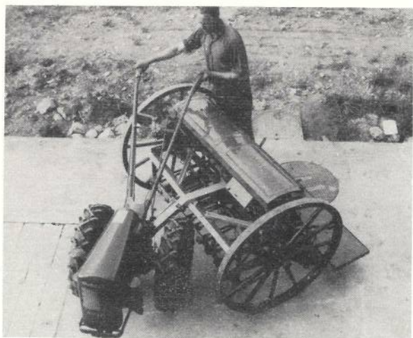
Abb. 4 Einachsschlepper im Hopfengarten. Dank seiner grossen Beweglichkeit ist er mit besonderem Vorteil in engen Sonderkulturen zu verwenden. Dia 6/53
