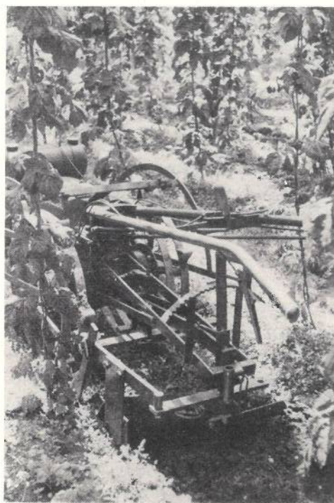
Abb. 4 Einachsschlepper im Hopfengarten. Dank seiner grossen Beweglichkeit ist er mit besonderem Vorteil in engen Sonderkulturen zu verwenden. Dia 6/53
