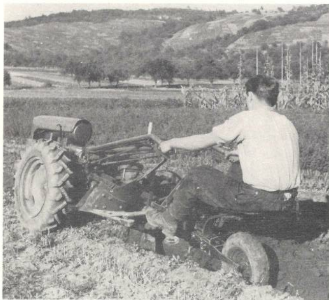
Abb. 2. Der schwere Einachsschlepper leistet mit der Anbauegge erheblich mehr als ein Pferdegesspann.
