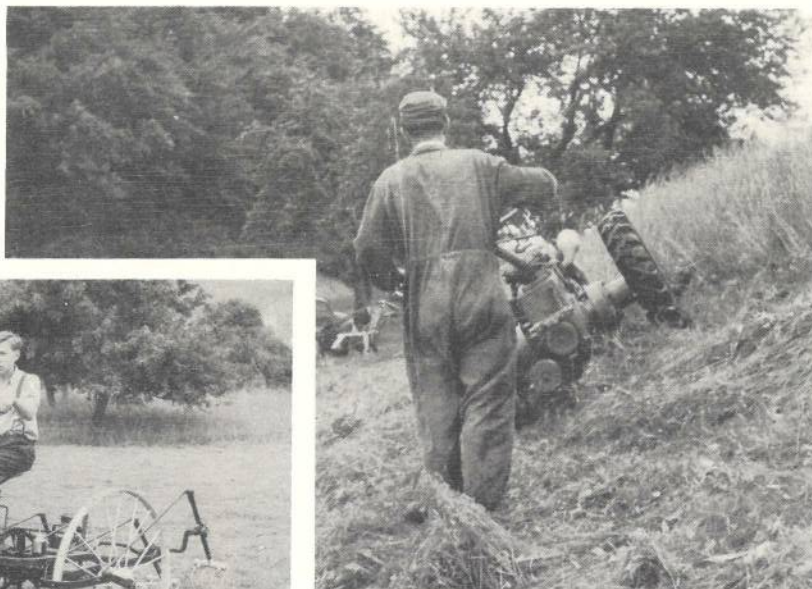
Abb. 6. Einachsschlepper beim Mähen am Steilhang. Arbeit mit dem Vordermäherwerk in der Schichtlinie.
