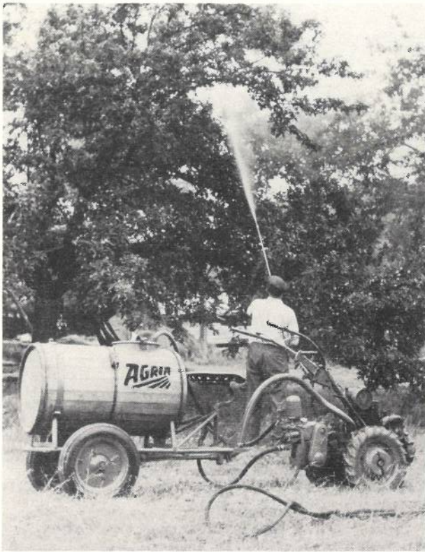
Abb. 13. Leichter Einachsschlepper mit Fasskarren und Anbaupumpe bei der Schädlingsbekämpfung.
