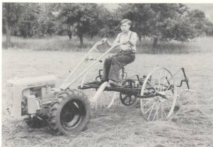
Abb. 7. Gespanngabel-Heuwender durch einfache Veränderung an der Deichsel geeignet für den Einachsschlepper.
