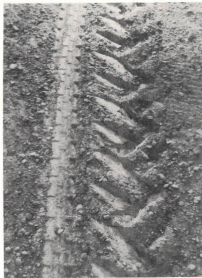
Von links nach rechts, Bild 1: Oben normale Achse, unten Stufenachse am Querhang, schematisch dargestellt ( G = Gesamtschwerpunkt des Fahrzeugs). Bild 2: Abgescherter Profilabdruck eines Normalschleppers am Hang, Bild 3: nicht abgescherter Profilabdruck eines Stufenschleppers unter gleichen Bedingungen.
