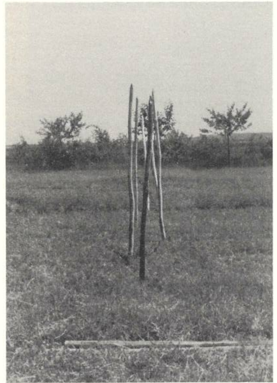
Abb. 3: Schnurreuterstangen, fertig zum Ziehen der Schnur in den Boden eingesteckt. Der Blick von der Stirnseite her zeigt die verschränkte Aufstellung der mittleren Stangen, die wechselseitig 10–15 cm von der gedachten Mittellinie eingesetzt werden. Dia 93/52
