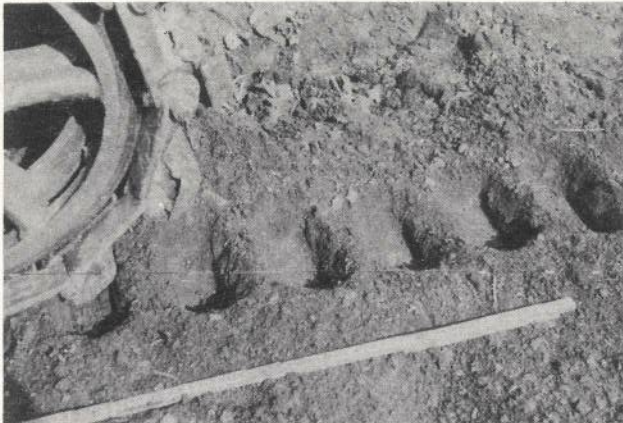
Abb. 4: Besonders bodenschonend und griffig ist die Gummipolsterkette an einer Kleinraupe.
