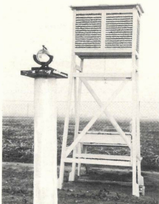
Abb. 1a (links). Thermometerhütte, Aussenansicht. (Im Vordergrund ein Sonnenscheinautograph zur Bestimmung der Sonnenscheindauer.)
