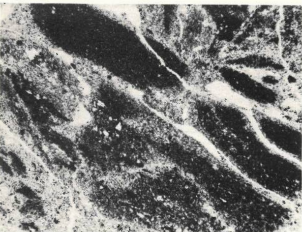
Bild 2: Tonige Grundmasse mit eingesprengten Schiefertongplättchen aus dem Lettenkeuper von Böttingen, Kreis Gundelsheim/Neckar. Tongehalt 68 %. Die Schiefertongplättchen üben als Gesteinsreste noch eine schwache Skelettfunktion aus und sind daher für die Durchlüftung des Bodens bedeutsam. In der Schlämmanalyse treten diese Reste nicht in Erscheinung, da sie dispergiert werden und dem Tongehalt zufallen. Dünnschliff, M 60 : 1.
