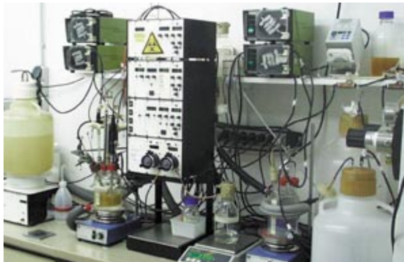
Abb. 3: Der Versuchsaufbau im Labor für die kontinuierliche Fermentationsführung mit einem Reaktionsvolumen von 0,5 l.
