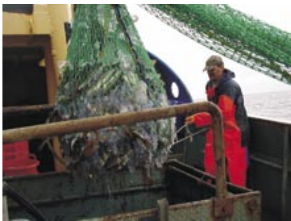
Abb.1: Ein T90-Steert wird an Bord eines kommerziellen Kutters gehievt - Codend for Baltic cod in T90 configuration.
