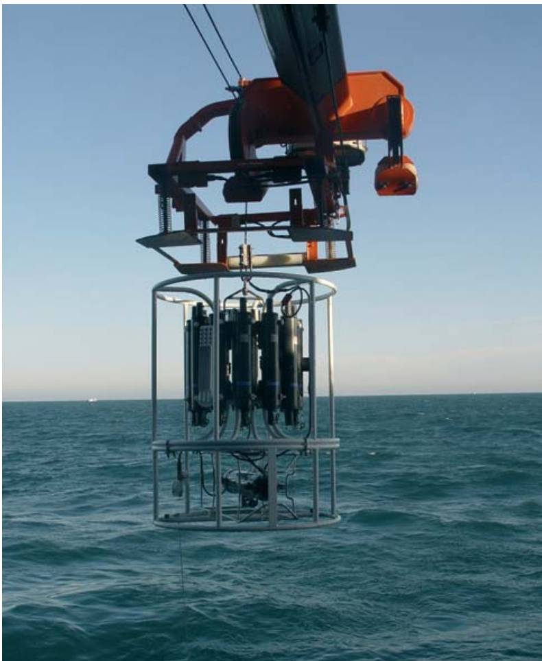
Abb. 3: Die Seabird-Sonde wird mit dem Einleiterkabel der „Walther Herwig III“ in die Meeresoberfläche gesenkt, um anschließend mit einer Fiergeschwindigkeit von 1 m/s bis zum Meeresboden gefahren zu werden.
