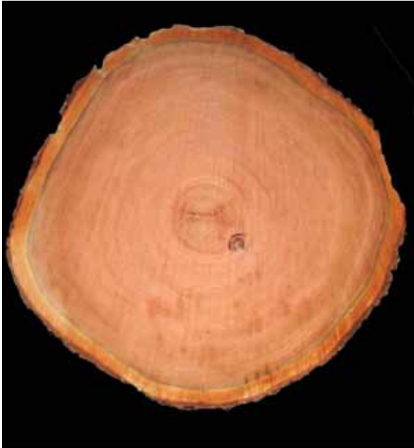
Abbildung 7: Stammscheibe von Amerikanischem Kirschbaum in Furnierqualität; Baualter ca. 100 Jahre, Durchmesser ca. 80 cm
