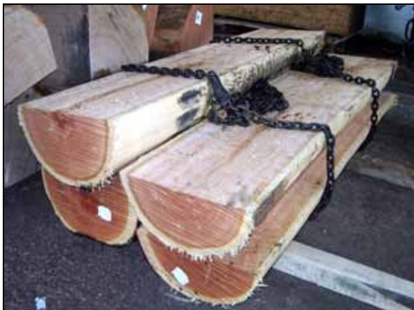
Abbildungen 10 und 11: Versuchsstämmen vor der thermischen Behandlung und vor der Aufarbeitung zu Messerfurnieren
