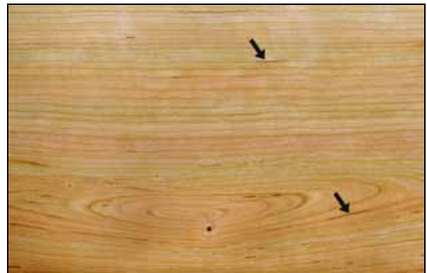
Abbildung 6: Ausschnitt aus einem Furnierblatt des Amerik. Kirschbaums mit starken Farbabweichungen und Harzeinlagerungen (Gumenbildung, siehe Pfeile)
