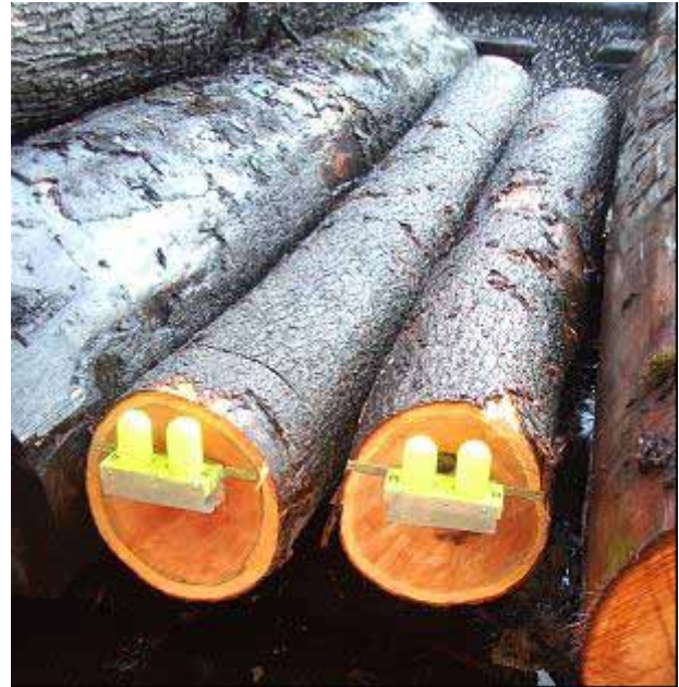
Abbildung 8: Versuchsstämme für Praxisversuche zur Furnierherstellung auf dem Holzlagerplatz des Furnierwerks Winsen mit Datenschreibern zur Dokumentation der Lagerungsbedingungen (Luftfeuchte und -temperatur)
