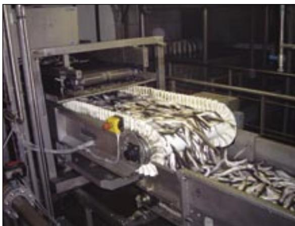
Abbildung 4: Wiegeband der Bandwaagenanlage mit darüber liegendem Entwässerungsgitterband.
