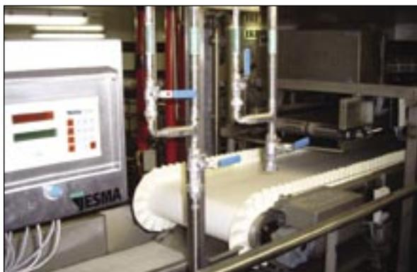
Abbildung 1: Bandwaage in der Euro-Baltic Fischverarbeitungs GmbH – *Figure 10 Flow scale of the fish processing company Euro-Baltic..*
