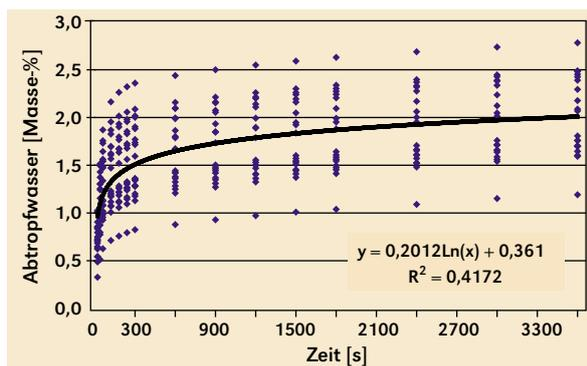
Abbildung 8: Anteile Haftwasser aus allen Versuchen mit Regressionskurve.
