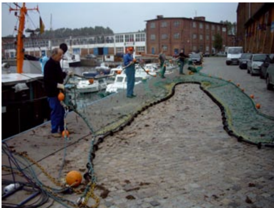
Abbildung 6: Das im Oberblatt reduzierte Grundschleppnetz „Topless 1“.
