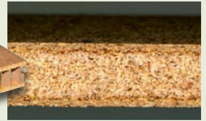
Abb. 3: Schaumkernplatte im Querschnitt
