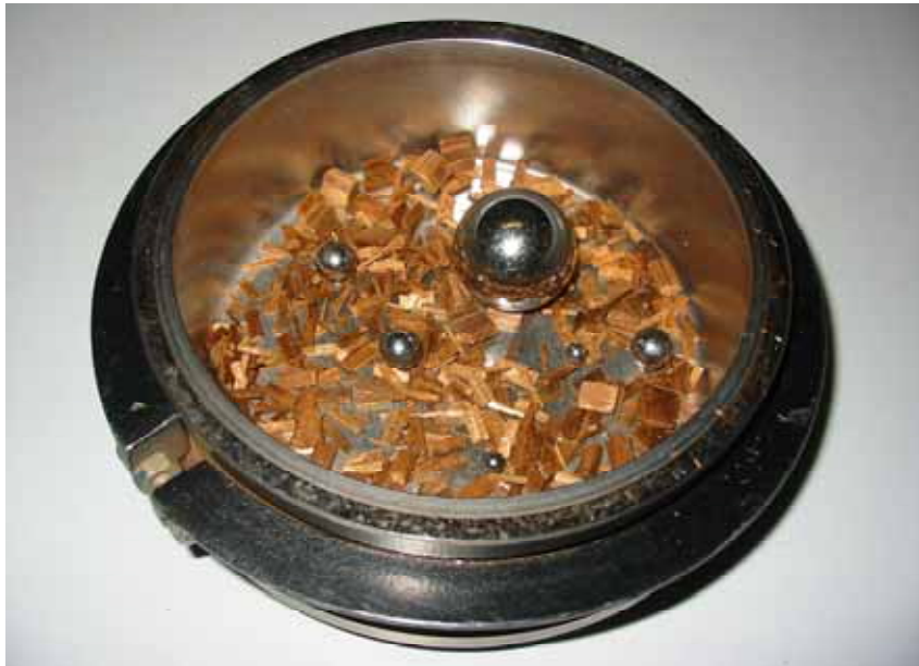
Abbildung 2: HEMI-Prüfung: Edelstahlschlagbecher samt Fragmenten und Stahlkugeln
