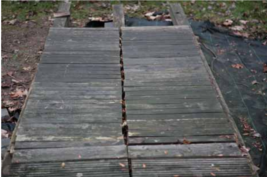
Abbildung 30: Oberlage der Laborplatten nach 24-monatiger Freibewitterung
