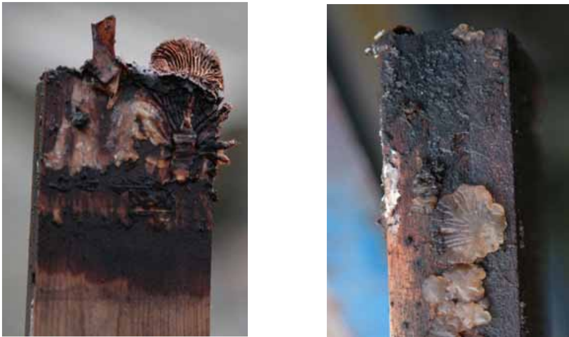
Abbildung 32: Fruchtkörper an Plattentyp-Nr. 298 (links) und -Nr. 290 (rechts)
