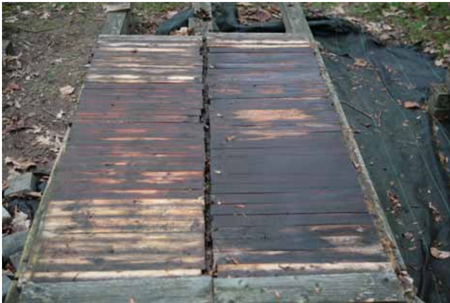
Abbildung 31: Unterlage der Laborplatten nach 24-monatiger Freibewitterung
