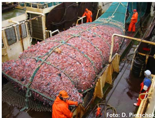
Ein voller Steert auf einem kommerziellen Trawler. A full cod-end on a commercial trawler.
