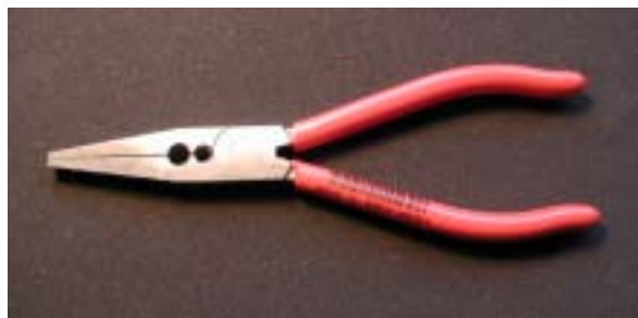
Abbildung 2: Schema einer Prüfzange zur Kontrolle von Netzgarnstärken. Die offiziell zugelassene Prüfzange wird zukünftig nur von einem europäischen Hersteller geliefert werden und befindet sich zur Zeit noch in der Ausschreibung.
