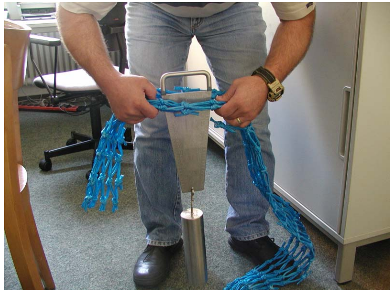
Abbildung 1: Benutzung eines Messspatens mit angehängtem 5-kg-Gewicht. Use of a wedge gauge with 5 kg weight attached.
