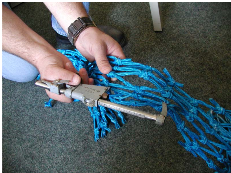
Abbildung 2: Das ICES-Maschenmessgerät im Einsatz. The ICES mesh gauge in operation.
