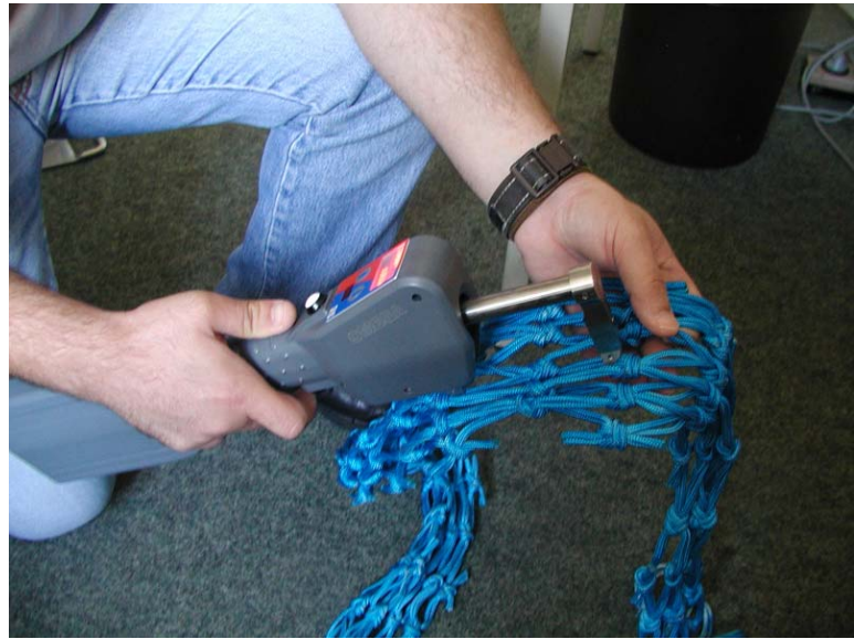
Figur 3: Das neue OMEGA-Maschenmessgerät im Einsatz. The new OMEGA mesh gauge in operation.
