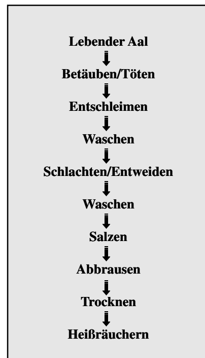
Abbildung 1: Fließschema der Herstellung von Räucheraal Flow chart for production of smoked eel.
