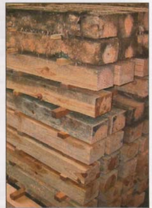
Abbildung 2 Schadbilder hitzebehandelter Proben nach zweiwöchiger Lagerung unter Folie. Die obere Reihe zeigt Proben ohne zusätzliche Behandlung; die darunter liegenden Reihen wurden mit verschiedenen Substanzen behandelt.
