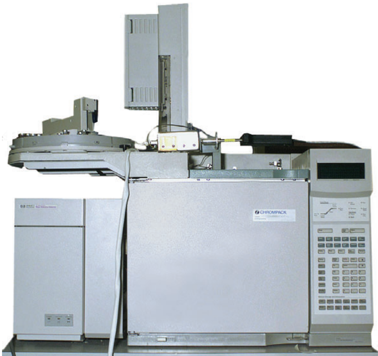
Abb. 4: GC/MS-Analysensystem mit Pyrolyseaufsatz für feste Holzproben (Mitte) und automatischem Probengeber für die Injektion flüssiger Proben.
