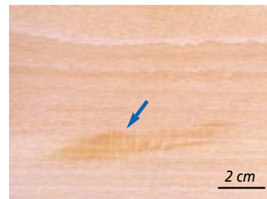
Abb. 9: Lokal begrenzte, fleckige Farbänderungen auf einem gedämpften Buchenbrettabschnitt
