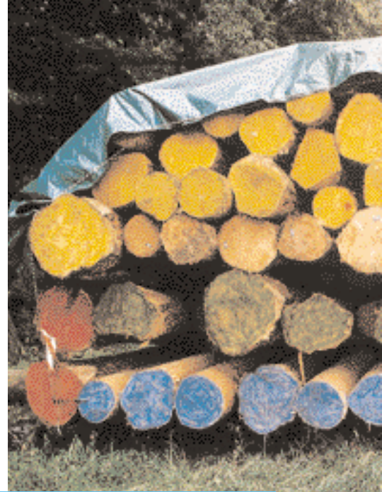
Abb. 2: Alternative Lebenswege von Bauholz: Verfahren A (chemischer Holzschutz, Einbau in nassem Zustand); Verfahren B (technische Trocknung); Verfahren C (Rundholztrocknung im Wald mit anschließendem Einschnitt zu trockenem Bauholz)
