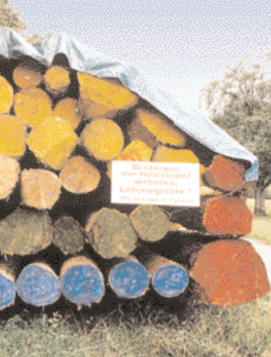
Abb. 1: Rundholz-Lagenpolter am Waldrand. Im Rahmen des Demonstrationsprojektes wurden die Stämme farblich markiert, um den Trocknungsfortschritt in Abhängigkeit von der Lage im Polter zu untersuchen.
