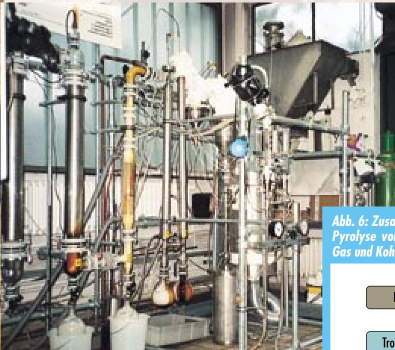
Abb. 5: Die Flash-Pyrolyseanlage der BFH im Betrieb. In den Rundkolben wird das Pyrolyseöl aufgefangen (5 kg/h)
