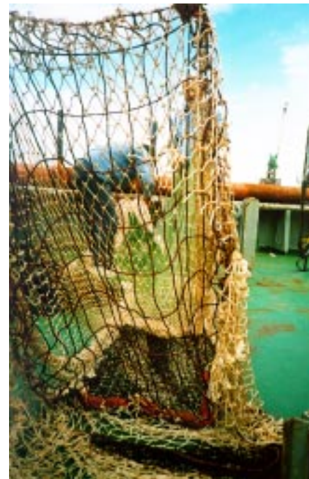
Abb. 5: MariNPO-Selektionssteert an Deck von FFK „Solea“
