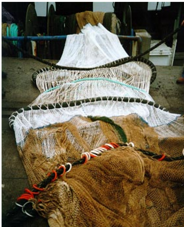
Abb. 2: Flexibles Heringsselektionsgitter RESR6 vor der Netztrommel des Kutters SH 10 Flexible herring sorting grid RESR6 in front of net drum
