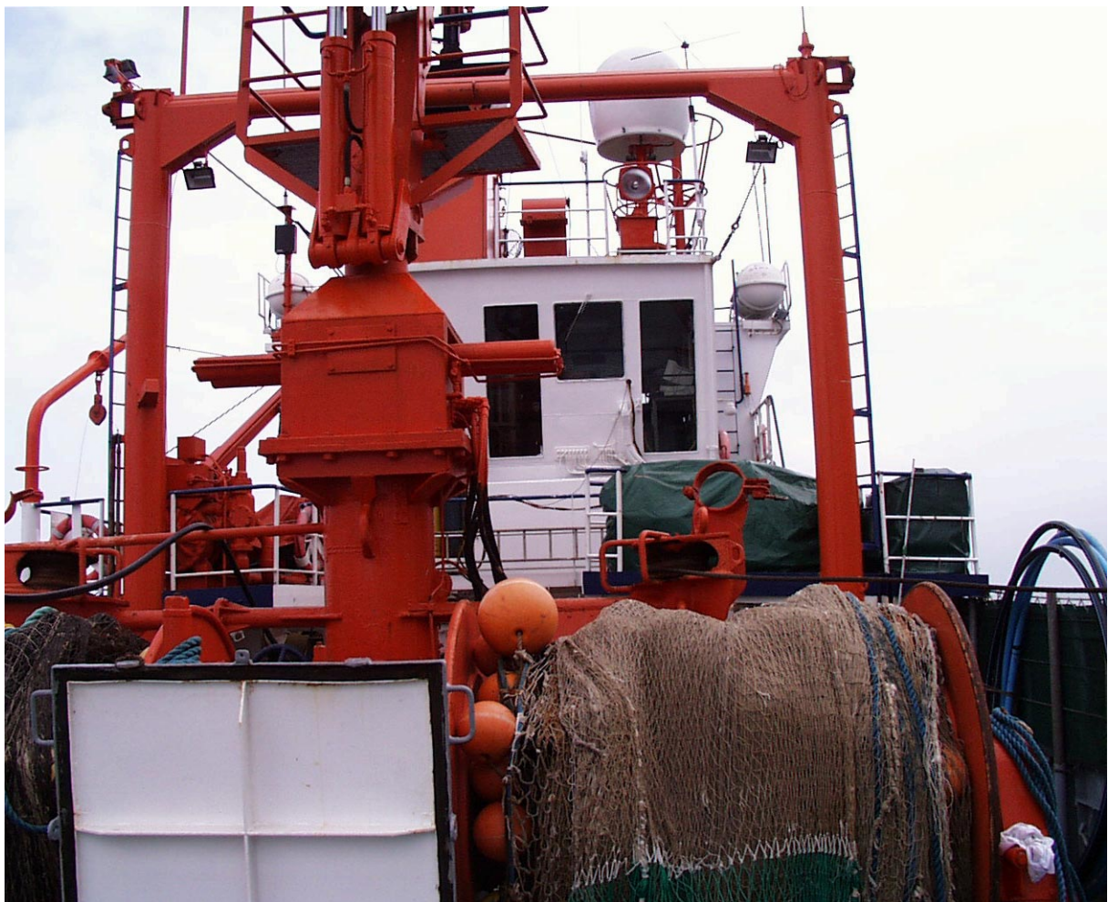
Decksaufbauten des FFK „Solea“: Portal, Bordkran (3 t), Netztrommeln
