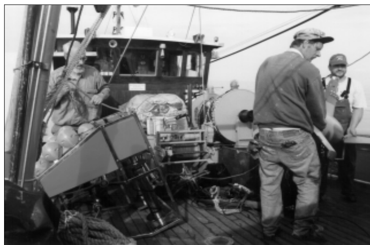
Abbildung 5: Kameraträger mit Rotorsteuerung und STIPS-TV (Surface Towed Intelligent Power Supplying Transmitting Vehicle) an Bord von „Clupea“ Rotor steered camera vehicle and STIPS-TV on board „Clupea“
