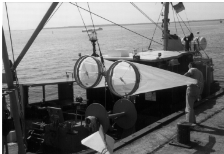
Abbildung 3: Bongo-Netz für fischereibiologische Untersuchungen Bongo net for fishery biological investigations
