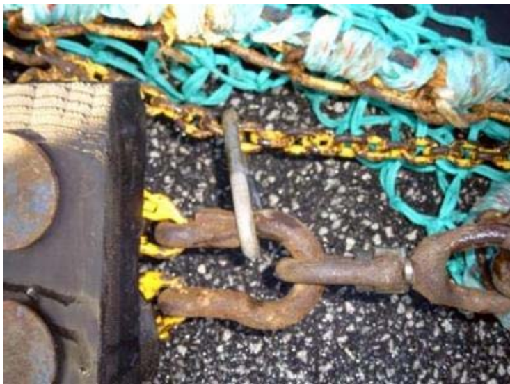
Abbildung 5: Arretierung der Verbindung von Platten- und Rollersektion mittels Quicklink
