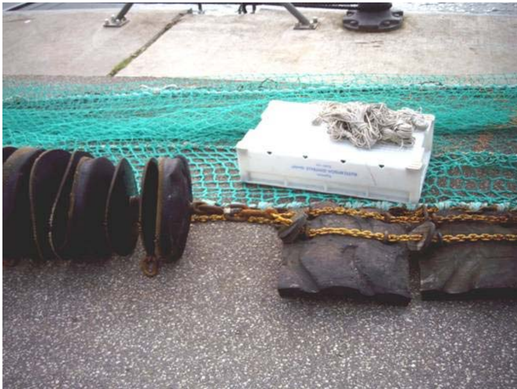
Abbildung 3: Übergangsbereich zwischen Roller-Mittelsektion und Platten-Flügelsektion
