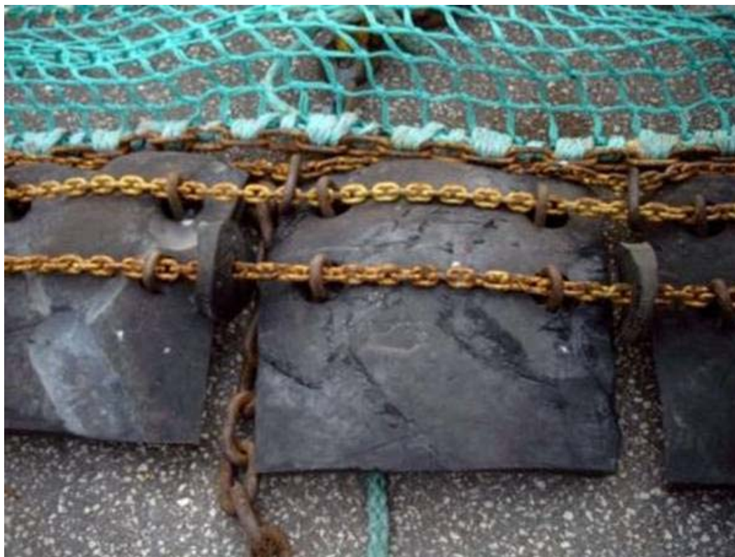
Abbildung 1: Einzelansicht von Gummiplatten aus Altreifenmaterial und Verbindungselemente im Grundtauvorgeschirr eines Schleppnetzes
