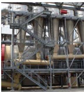
späteren Deck- oder Mittelschicht der Platte. Im Wesentlichen handelt es sich hierbei um eine kontinuierliche Konvektionstrocknung,
