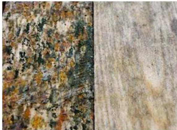
Abbildung 1: Struktur des Pilzbefalles auf hitzebehandeltem (links) und nicht- hitzebehandeltem (rechts) Kiefernspiltholz nach zweiwöchiger Lagerung unter Folie in sehr feuchtem Klima (LAMBERTZ 2005).
