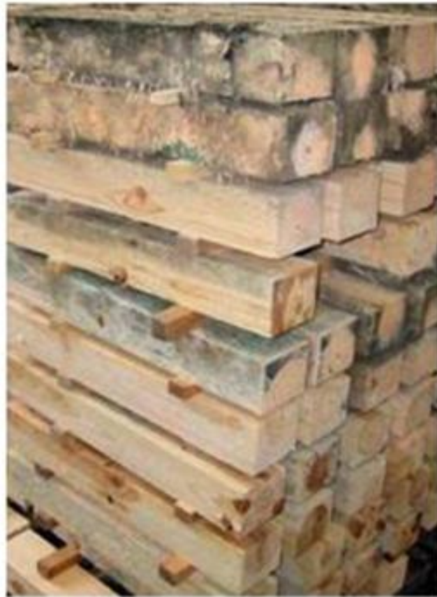
Abbildung 2: Schadbilder hitzebehandelter Proben nach zweiwöchiger Lagerung unter Folie. Obere beiden Reihen ohne zusätzliche Behandlung; darunter liegende Reihen mit verschiedenen Substanzen behandelt (LAMBERTZ 2005).
