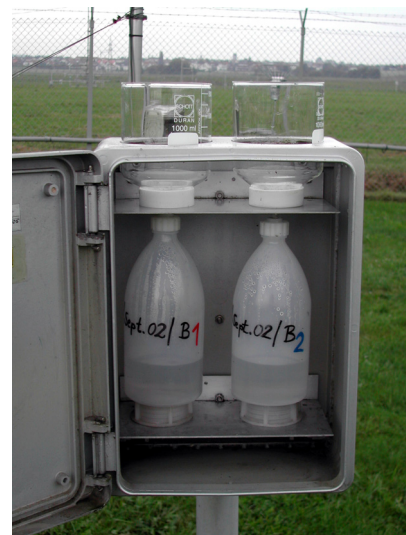
Abbildung 2: Aufbau der Rotenkamp-Sammler B91 (Dämmgen et al. 1994). Je ein Sammler mit basischer und mit saurer Vorlage werden gemeinsam exponiert.
