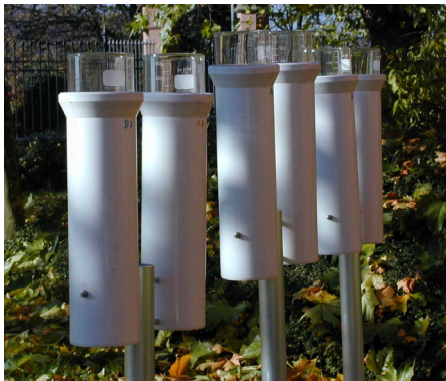
Abbildung 4: Aufbau der Rotenkamp-Sammler B01. Je ein Sammler mit basischer und mit saurer Vorlage werden gemeinsam exponiert.
