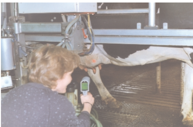
Abb. 1: Zur Bewertung der mechanische Belastung von Euter und Zitzen wurden Infrarot-Messungen der Oberflächentemperaturen vor und nach dem Melken durchgeführt
