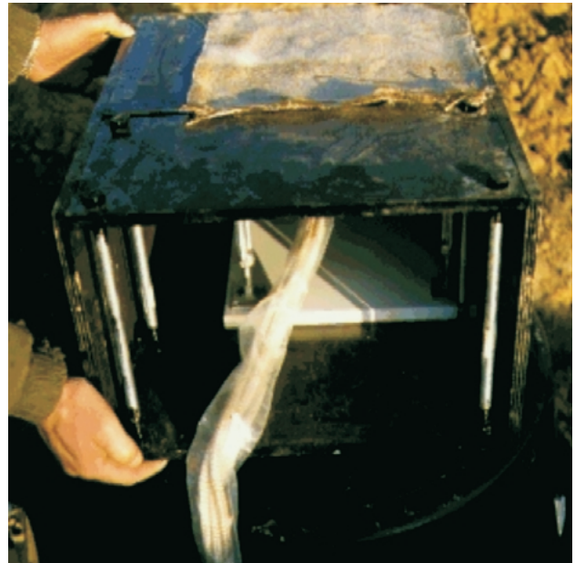
Abb. 4: Sickerwasserprobenehmer zur Beprobung der Bodenlösung in wasserführenden Poren
