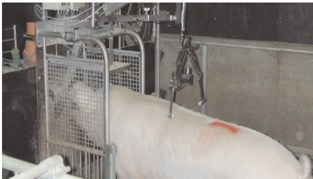
Abb. 12: Mechanik zur automatischen Messung der Rückenspeckdicke von Sauen. Der Messarm mit dem Sensor ist auf den Rücken des Tieres abgesenkt
