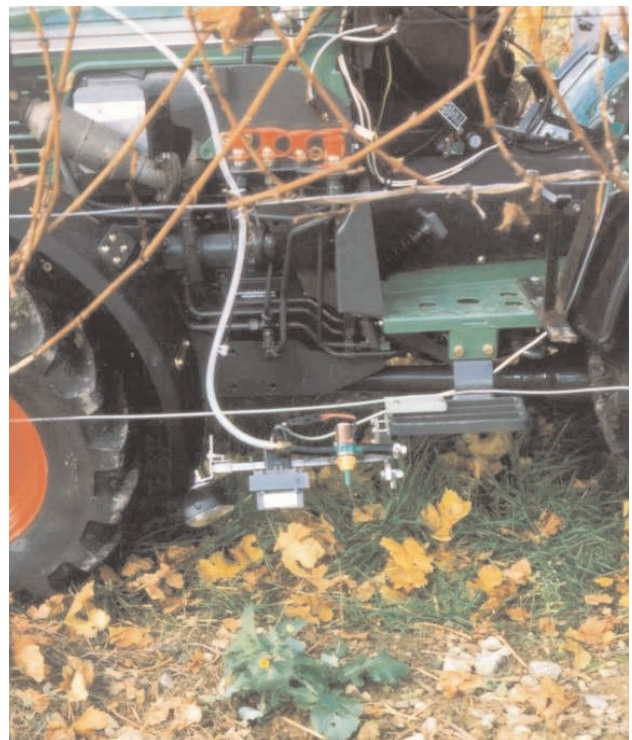
Abb. 7: Optoelektronisches 'System IBB' zur gezielten Unkrautbekämpfung in Weinbergen
