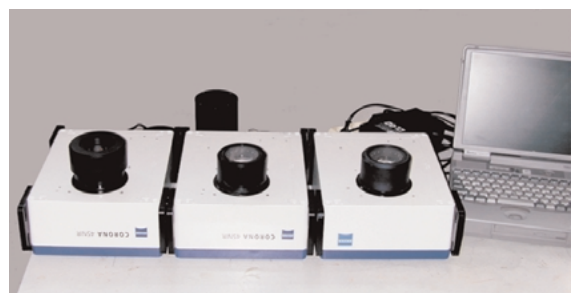
Abb. 15: Vergleichsmessungen mit drei InGaAs Diodenarray-Spektrometern
