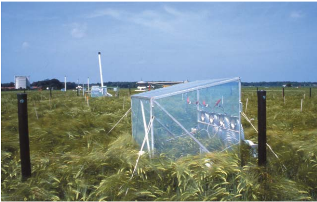
Abb. 14: Kammersystem zur Messung der CO 2 - und H 2 O-Flüsse von Wintergerstenbeständen
