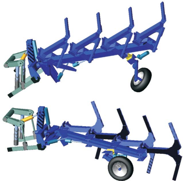
Abb. 1: ADAMS-Simulationsmodell des Rabe-Versuchspflugs
