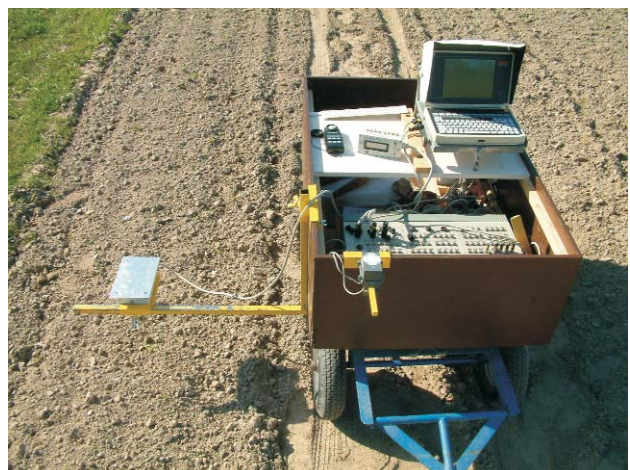
Abb. 7: Messwagen zur Messung der Reflexion des Umgebungslichts durch verschiedene Pflanzen
