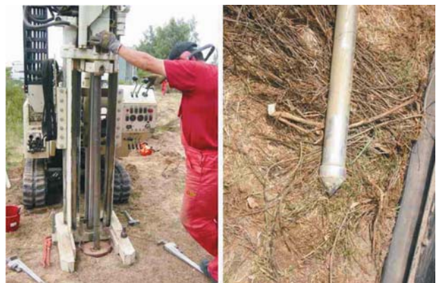
Abb. 4: Bohrungen mit dem Geoprobe-System zur Entnahme von Sedimentproben aus großen Bodentiefen (links), Bohrkern nach der Entnahme (rechts)
