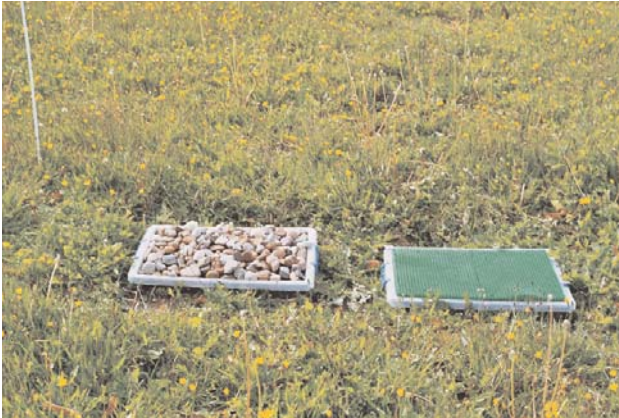
Abb. 22: Partikelsammler auf dem konservierten Klärschlammversuch, FV 1, Braunschweig 2003
