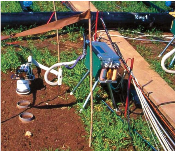
Abb. 9: Photosynthese-Messgerät mit Bodenkammer (Li-cor 6400-09) zur Messung der Bodenatmung
