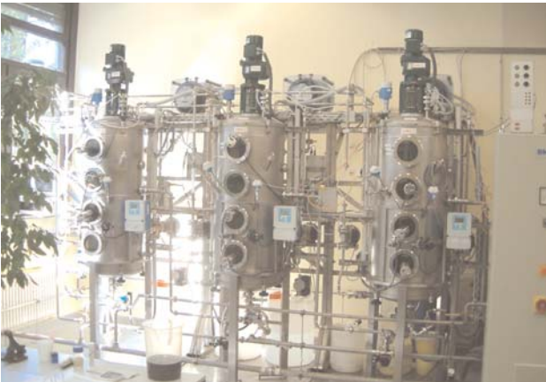
Abb. 19: Foto der Pilotanlage zur Bioethanolherstellung. Gebaut durch den Projektpartner, die Braunschweigische Maschinenbauanstalt (BMA)
