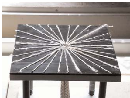
Abb. 3: Glasfaser-Passivsickerwassersammler zur Ermittlung der Auswaschungsdynamik in ungestörten Bodenprofilen; (A) Anordnung der Glasfaserfilamente auf der Andrückplatte, (B) fertiger Sickerwassersammler, (C) PACPS nach dem Einbau in einen Boden
