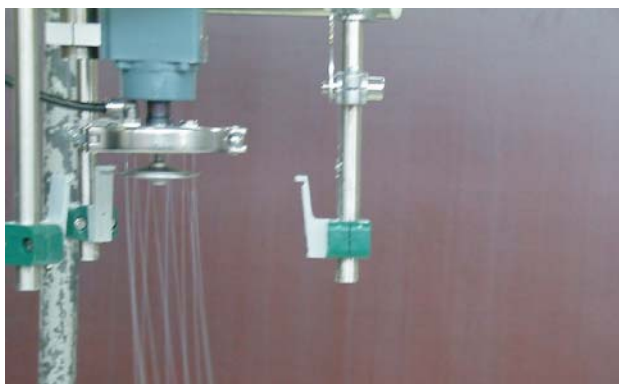
Abb. 6: Applikation von Wasser plus Viskositätserhöher mit dem Strahlschneider bei einer Windgeschwindigkeit von 5 m/s
