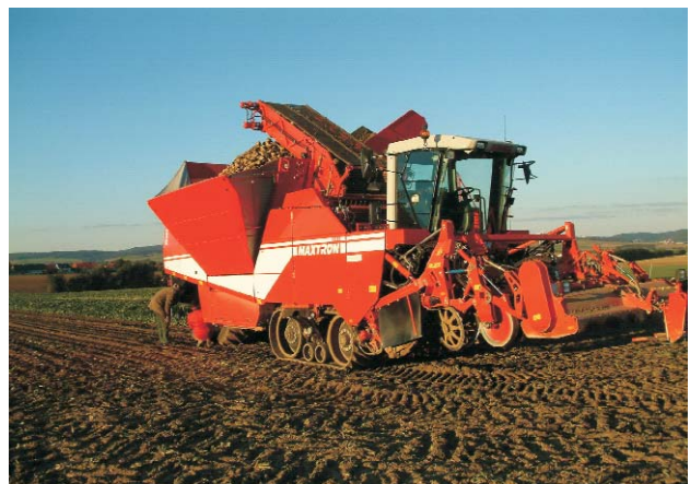
Abb. 4: 6-reihiger Köpfrdebunker (KRB) mit Gummibandlaufwerk
