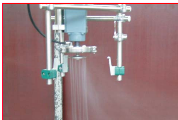
Abb. 5: Applikation von Wasser mit dem Strahlschneider bei einer Windgeschwindigkeit von 3 m/s
