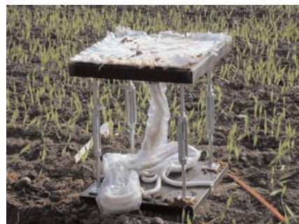
Abb. 3: Glasfaser-Passivsickerwassersammler zur Ermittlung der Auswaschungsdynamik in ungestörten Bodenprofilen; (A) Anordnung der Glasfaserfilamente auf der Andrückplatte, (B) fertiger Sickerwassersammler, (C) PACPS nach dem Einbau in einen Boden
