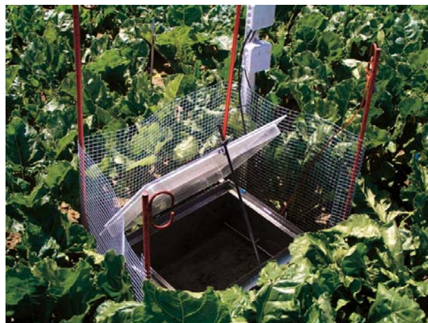
Abb. 14: Anreicherungskammer zur Bestimmung der Bodenatmung in einem Zuckerrübenbestand
