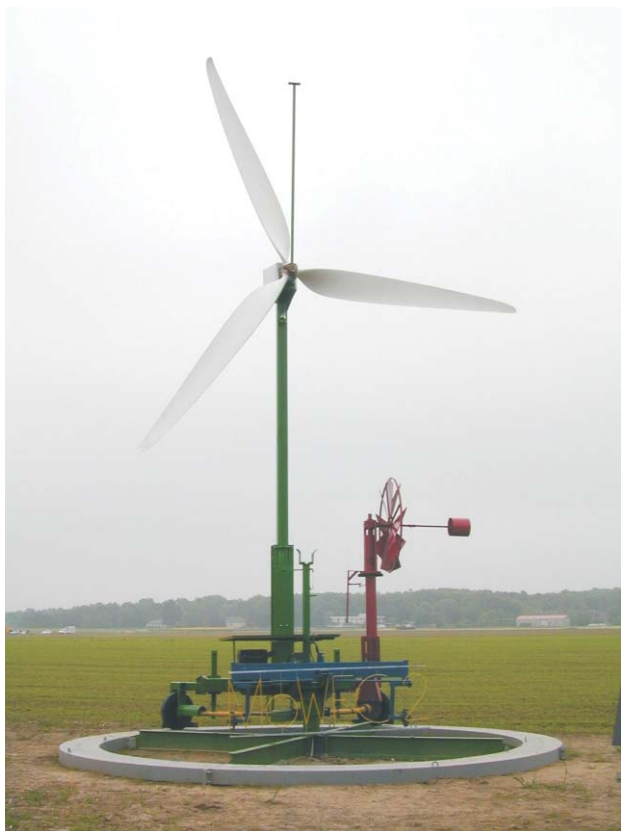
Abb. 10: MoWEC 2 am Einsatzort auf einem 16 cm hohen Fahrbahnring
