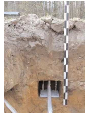
Abb. 3: Glasfaser-Passivsickerwassersammler zur Ermittlung der Auswaschungsdynamik in ungestörten Bodenprofilen; (A) Anordnung der Glasfaserfilamente auf der Andrückplatte, (B) fertiger Sickerwassersammler, (C) PACPS nach dem Einbau in einen Boden
