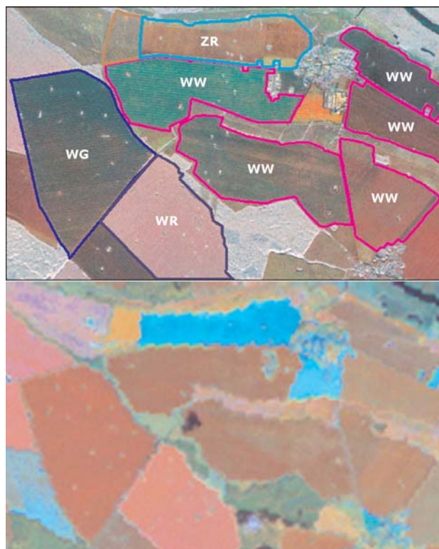
Abb. 10: Oben: Radarbild (RGB: X-vv/L-vv/L-hv), Unten: Zeitgleiche optische Satellitenaufnahme (RGB: 4/5/3) vom 09. Mai 2001
