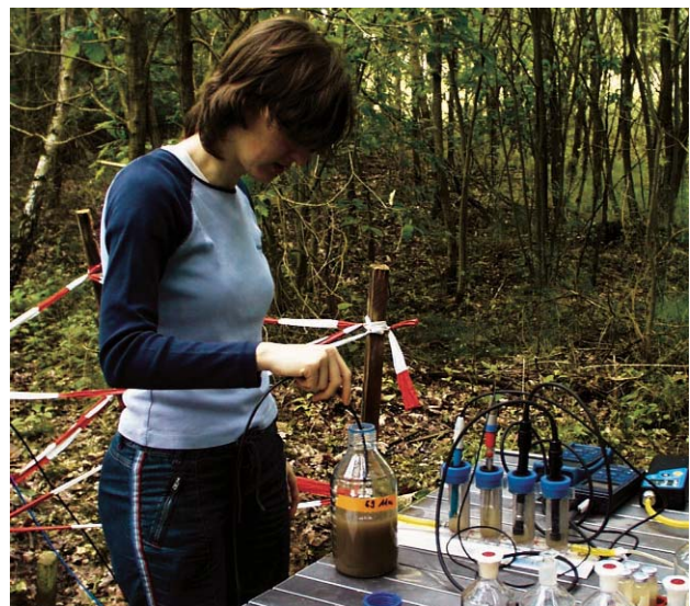
Abb. 5: Grundwasserprobenahme für molekulare Nachweise von TCE-abbauenden anaeroben Bakterien
