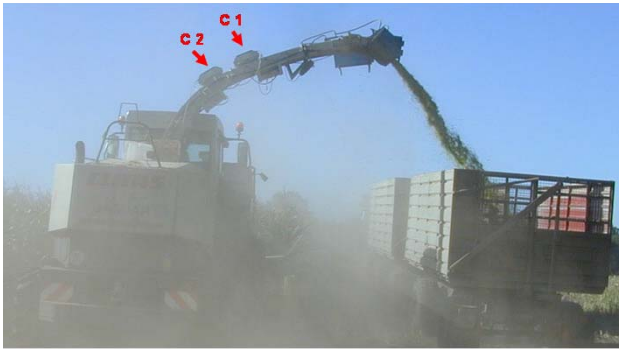
Abb. 15: Einsatz von zwei DA-Spektrometern CORONA (C1 und C2) zur parallelen Spektrenaufnahme während der Ernte von Silomais mit dem Jaguar 890
