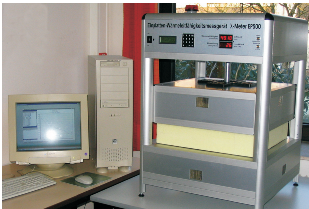
Abb. 10: Wärmeleitfähigkeitsmessgerät - Guarded hot plate apparatus
