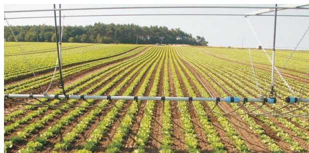
Abb. 3: Ausschnitt einer Linearberegnungsmaschine ausgerüstet mit mobiler Tropfbewässerung im Gartenbau - Detail of mobile drip irrigation with a linear move irrigation machine in vegetables
