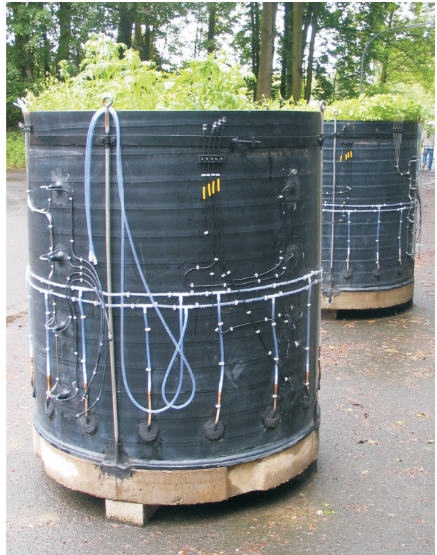
Abb. 1b: Lysimeterkörper - Lysimeter corpus
