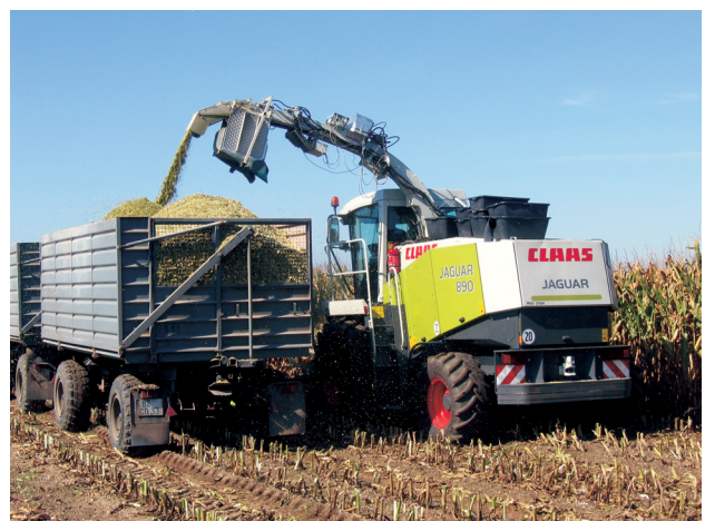
Abb. 7: Feldhäcksler Jaguar 890 mit Mess- und Probenahmeeinrichtung am Auswurfbogen - Chopper Jaguar890 with NIR DA instruments and sampling systems on the spout
