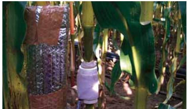
Abb. 4: Betrieb von Saftflussmanschetten an einzelnen Maispflanzen innerhalb der FACE-Ringe zur Quantifizierung der Behandlungseffekte auf den Wasserfluss der ganzen Pflanze - Operation of sap flow sensors for quantification of daily water loss per plant under the different treatments
