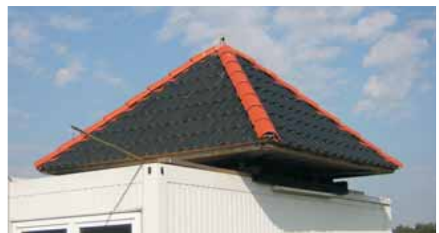
Abb. 7: Versuchsaufbau auf dem Messcontainer im Freigelände - Experimental setup on the measuring container in the open area ground
