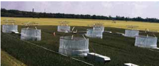
Abb. 6: Feldversuchsanlage aus open-top Kammern zur Ozonexposition von Winterweizenbeständen - Open-top field chambers for ozone exposure studies in a winter wheat field
