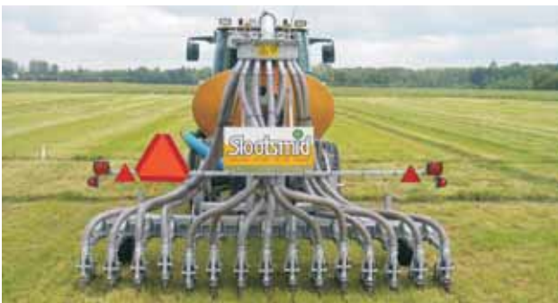
Abb 5: Gülle-Injektionsgerät - Injector for liquid manure on grassland
