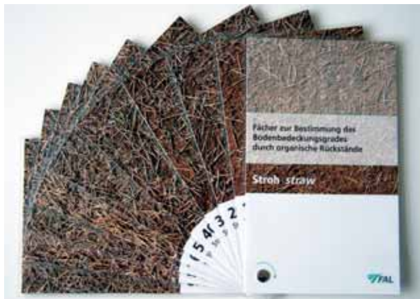
Abb. 2: Fächer zur Bestimmung des Bodenbedeckungsgrades durch organische Rückstände - Fan for determining the degree of soil cover by organic residues
