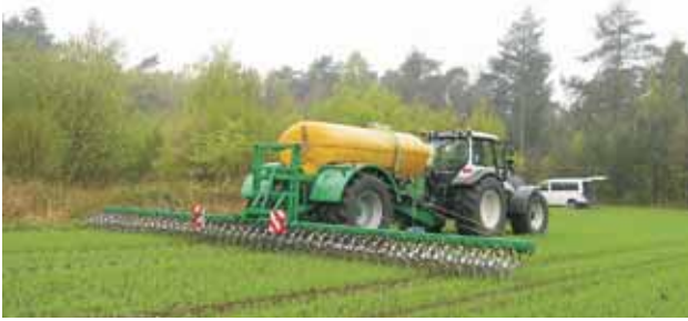
Abb. 4: Sternrad-Injektionsmaschine für Flüssigdüngerinjektion in den Boden - Spoke wheel injector for the fertilization according to the CULTAN strategy on farmer fields
