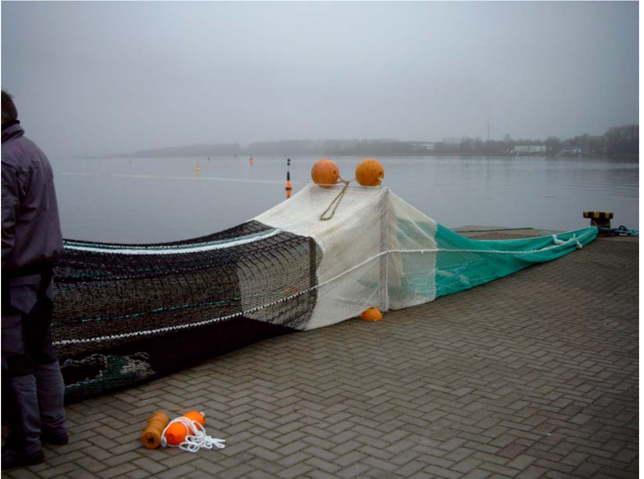
Abbildung 3: Fallbalkenrahmen in Adapterkragen (weißes Netzmaterial) eingestrickt, unter dem Rahmen (Backbordseite) ein Halbkugel-Kite
