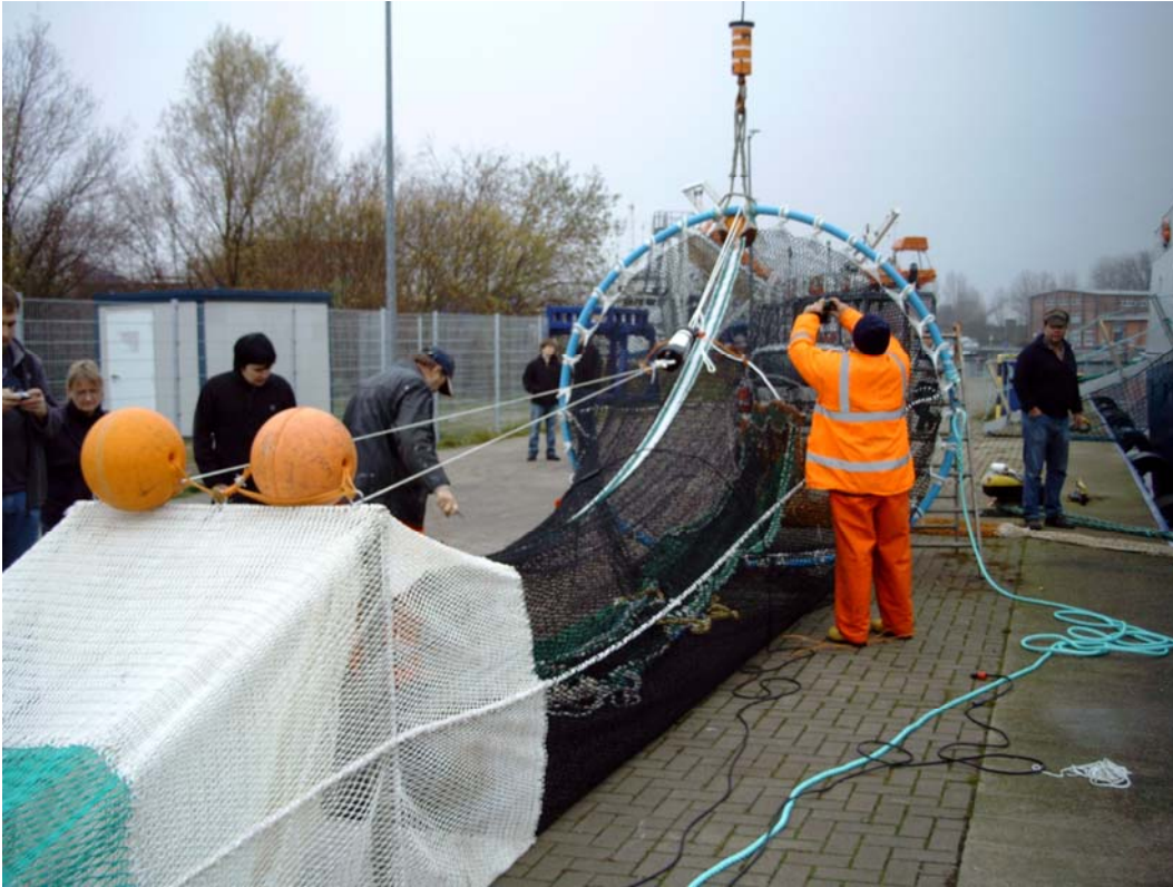
Abbildung 5: Anbringung des Auslösers zwischen Spreizring und Fallbalkenhahnepot
