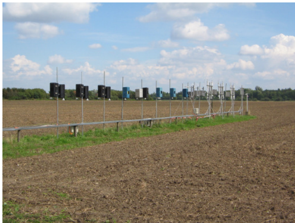
Abbildung 14 Feldexperiment zur Bestimmung der Verlässlichkeit und Genauigkeit von Ammoniak-Konzentrationsmessungen in der FAL, 2005 bis 2008.
