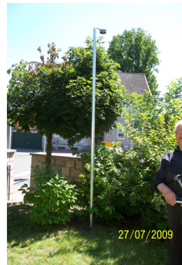
Abbildung 16 Aufbau der Messeinrichtungen zur Erfassung von Ammoniak-Konzentrationen im Raum Königslutter (Messstellen Mühlenriede und Stadtmitte) (Fotos: Jürgen Conrad, vTI)
