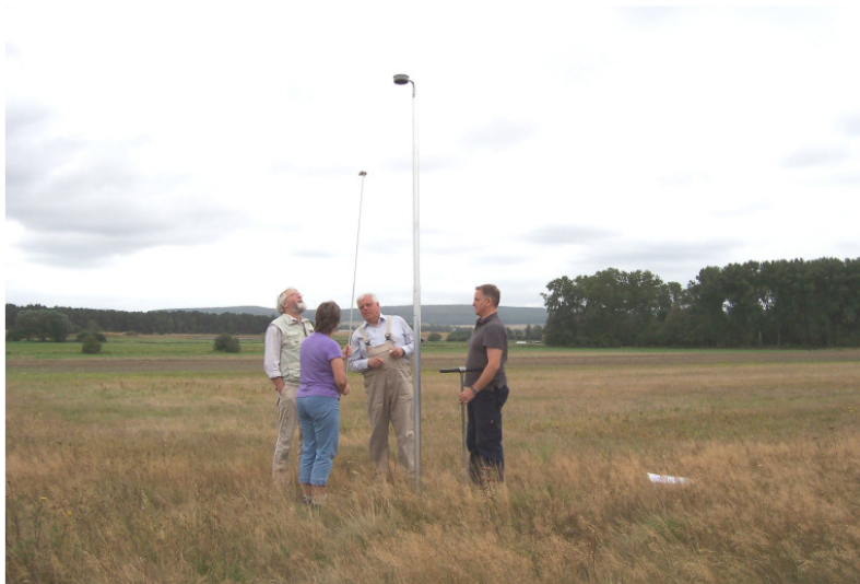
Abbildung 16 Aufbau der Messeinrichtungen zur Erfassung von Ammoniak-Konzentrationen im Raum Königslutter (Messstellen Mühlenriede und Stadtmitte) (Fotos: Jürgen Conrad, vTI)
