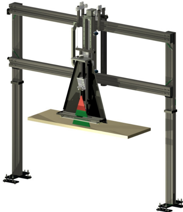
Abbildung 1: Konstruktionszeichnung des Online-Messsystems zur Faservermessung
