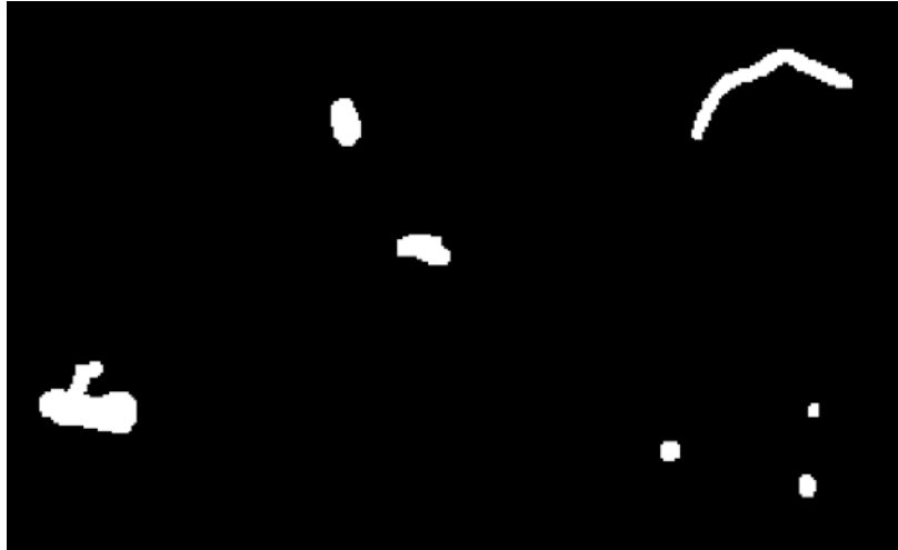
Abbildung 5-5: Nach dem Schwellwert-Verfahren lassen sich die einzelnen Zusammenhangskomponenten unabhängig voneinander untersuchen. In diesem Beispiel gibt es 7 Zusammenhangskomponenten.
