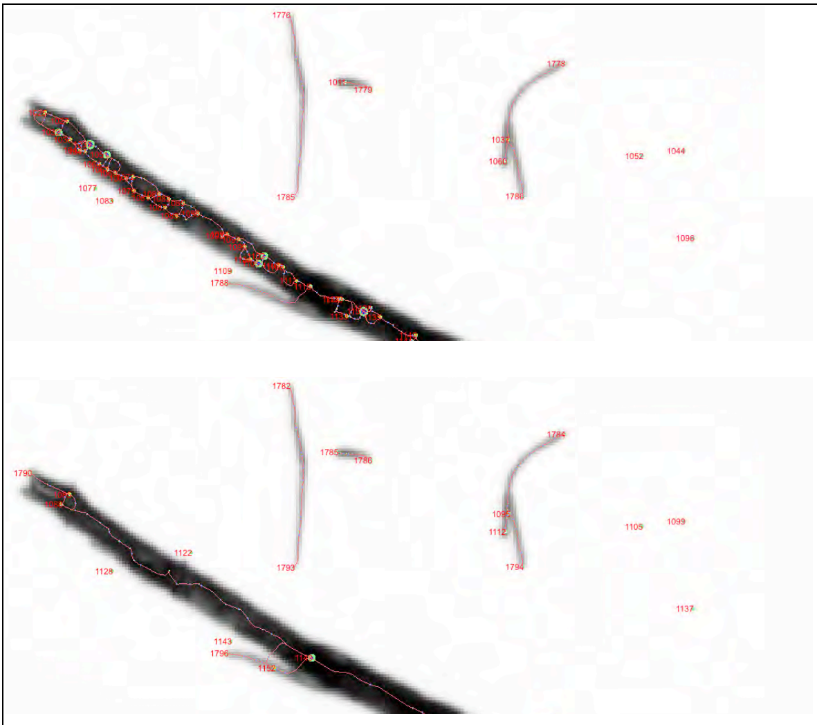
Abbildung 5-8: Resultierendes Faserskelett bei Gleichbehandlung aller abgebildeten Fasertypen (oben) und bei Sonderbehandlung der enthaltenen Shives (unten)
