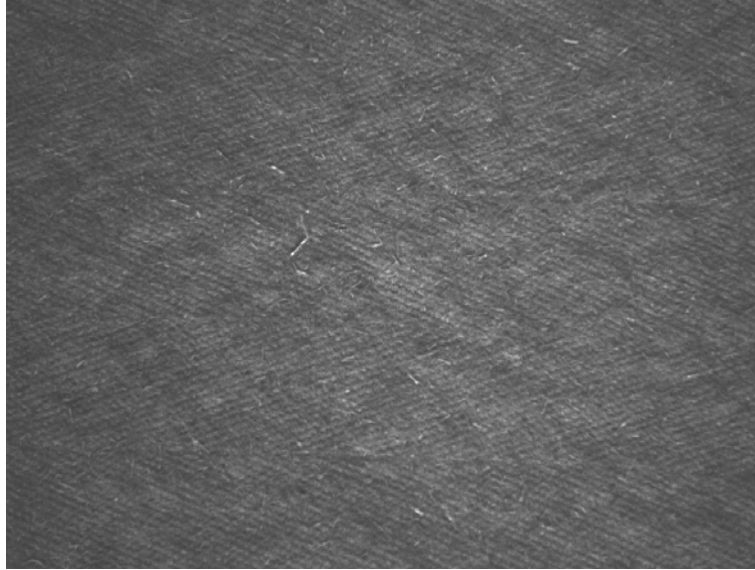
Abbildung 6-10: Beispielhaftes Bild des dritten Versuchsaufbaus. Deutlich zu erkennen ist die erhöhte räumlich Auflösung und die Struktur des Vorpressbandes
