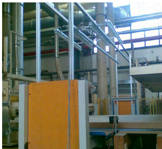
Abbildung 6-2: Versuchsaufbau 1: Die Leuchtstoffröhren hängen parallel neben der Kamera (Grecon).
