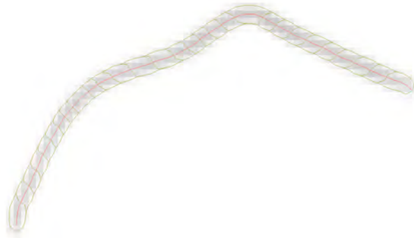
Abbildung 5-4: Segmentierung einer einzelnen Holzfaser. Gelb: Ergebnis der Subpixel-Wasserscheiden-Segmentierung, Rot: Berechnetes Subpixel-Skelett der Faser.
