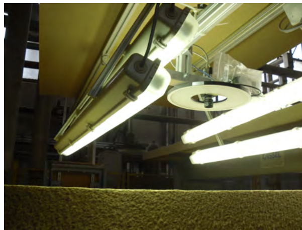
Abbildung 6-4: Versuchsaufbau 3: Die Kamera besitzt nun einen Blitz und befindet sich auf Höhe der Leuchten, eine Verschalung wurde angebracht (Grecon).
