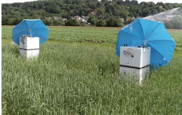
Abbildung 1: Gasflussmessung im Winterweizen auf dem Wiesengut.
