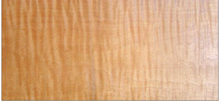
Abb. 1: Holzprobe (Tangentialschnitt) von Riegelahorn
