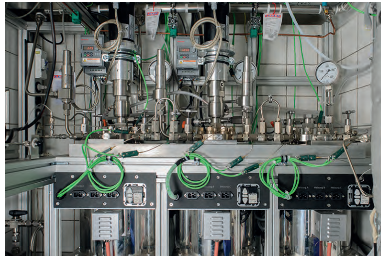
Pilotanlage zur Herstellung biogener Basischemikalien und Kraftstoffe bzw. Kraftstoffadditive aus Holz-Pyrolyseölen (© C. Waitkus/Thünen-Institut)
