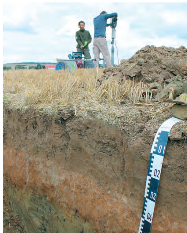
Beprobung eines Pseudogleys bei Helmstedt zur Erfassung der Bodenkohlenstoffvorräte
