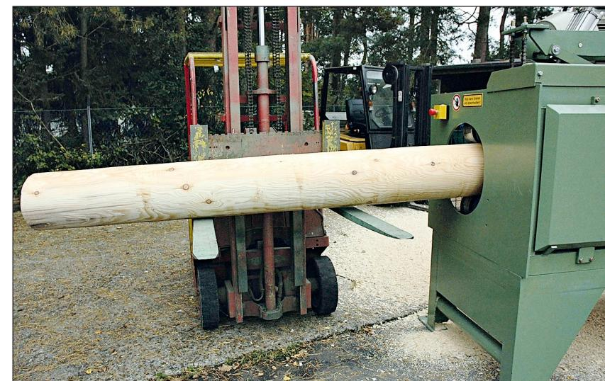
Abbildung 1 Splintfreie Rundhölzer können mit Rundstabfräsmaschinen bis zu einem Durchmesser von etwa 30 cm hergestellt werden. Fotos J. Müller (5)
