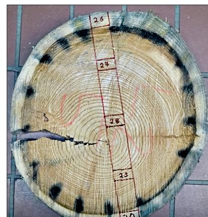
Abbildung 7 Zustand der mit Geotextil ummantelten (linkes Bild) und der nicht ummantelten Stammscheibe Nr. 5 (rechtes Bild) nach fünf Jahren Exposition in Norddeich
