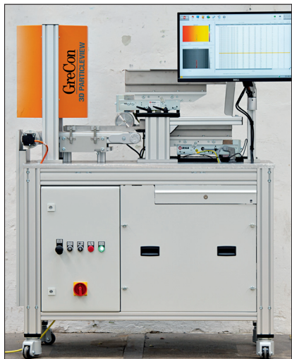
Messsystem „3D Particleview“ zur dreidimensionalen Spanvermessung Fotos: Jürgen Bartels
